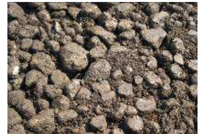
転圧後の根系誘導耐圧基盤の粒径が潰れていません。この空間に根が伸張します。
